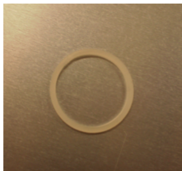
図 7.5 リング状に打ち抜いたサンプル
