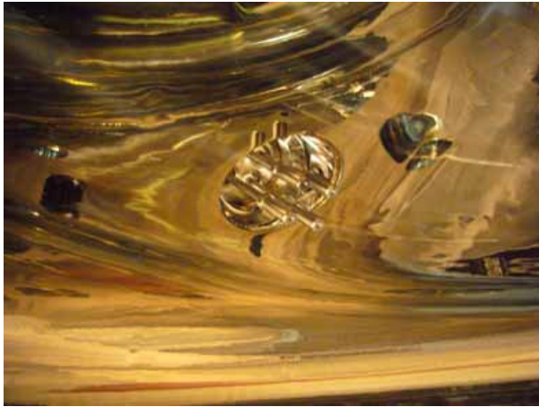
図 2.4.1 RT-1 の北側上フレンジに設置した電流導入端子、4 本の端子のうち上 2 本を C-coupling 用のアンテナに電圧をかけるのに使い、下 2 本をループアンテナに電流を流す用に使う。
