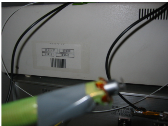
図 2.4.12 電界センサの先端
