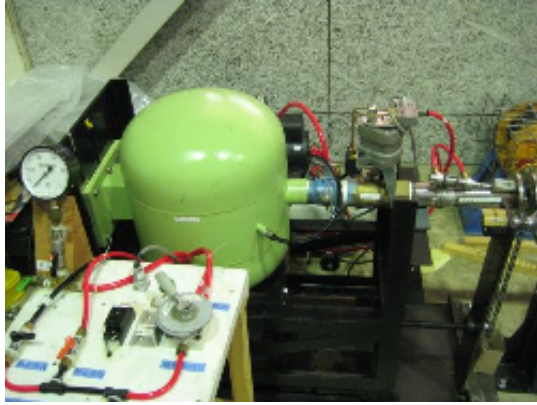
圧縮空気タンク
