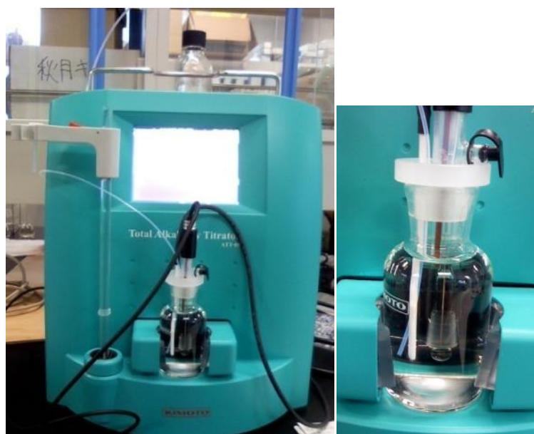
図 2.2-6 全アルカリ度滴定装置(左:全体図 右:採水ビンとセンサー類)
