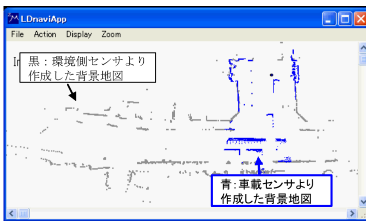
図 6.5 マップマッチングによる環境側センサと車載センサの座標系の統合
