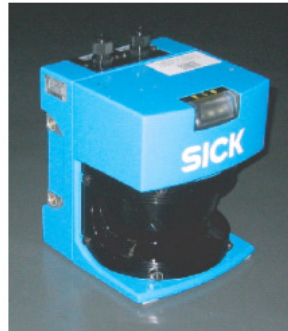
図 2.1 レーザスキャナ (SICK-LMS200)
