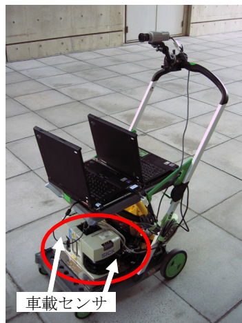
図 3.5 台車に設置した車載センサ
