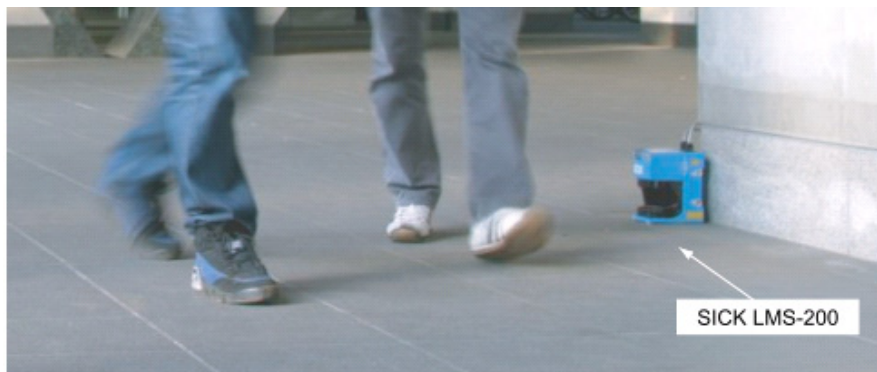
図 2.2 レーザスキャナによる歩行者計測の様子
