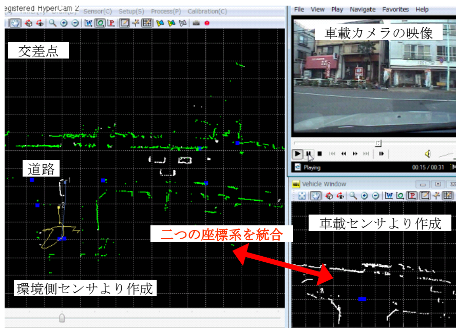
図 6.6 環境側センサと車載センサのそれぞれの情報
