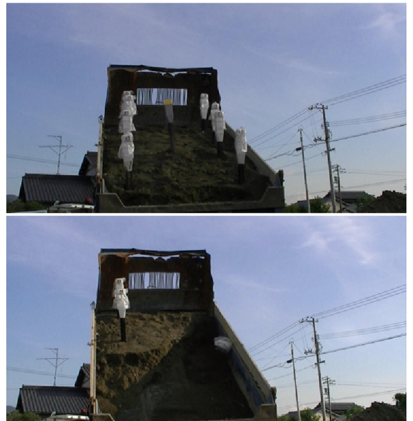
図 4.8 傾斜角度を変化させ崩壊させる。
