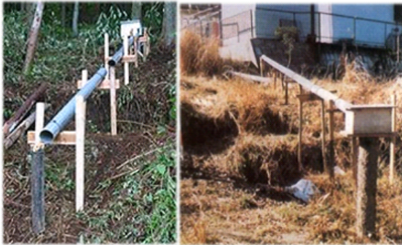
図 2.8 ひずみ計 (地表面変位計)
