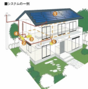
図 4-2-7-1 PV システムの例
