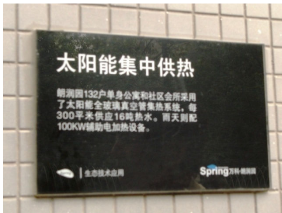
図4-1-11 太陽熱利用温水システム
