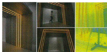
図 3,2,6 アルミリングモックアップと暖房時の表面温度
