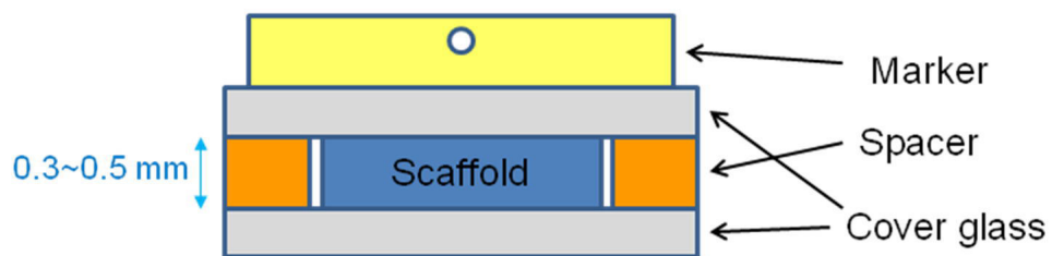
図 3-1 Scaffold 厚選定用観察装置の模式図
