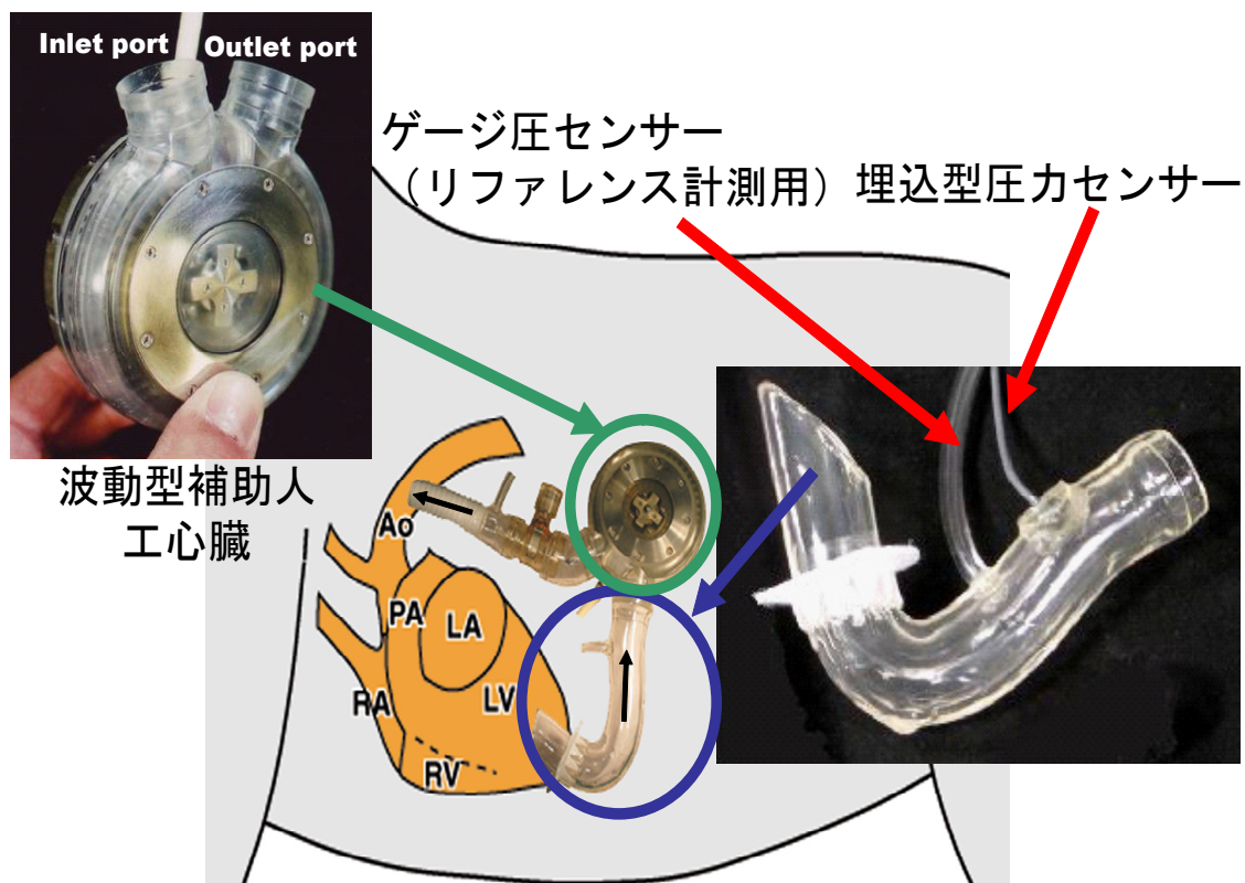
図 6.1 波動型補助人工心臓および埋込型圧センサーの装着方法
