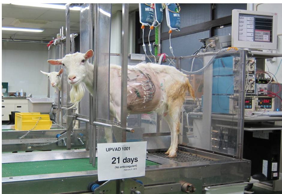
図 6.6 波動型補助人工心臓、体内埋込型圧センサーおよび胸腔内圧計測センサーを埋め込んだヤギ（術後 21 日目）
