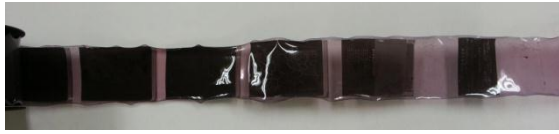
写真 I-1 ビネガーシンドローム
