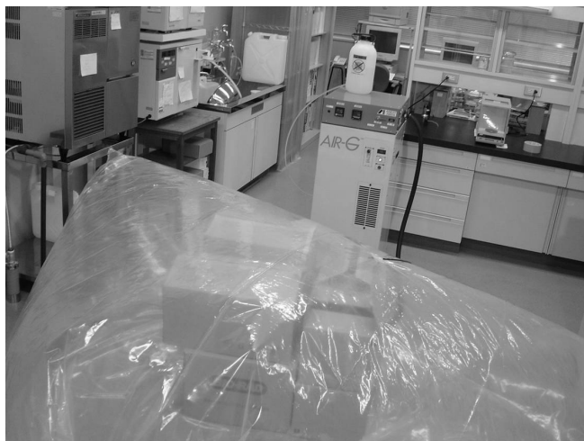
窒素発生装置による中規模の殺虫処理 (写真：木川りか)
