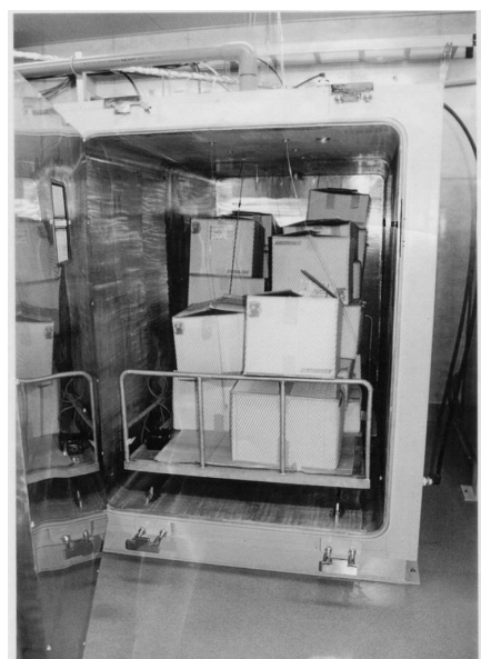
薫蒸装置の窒素処理殺虫装置 への改変(東京文化財研究所) (写真：木川りか)
