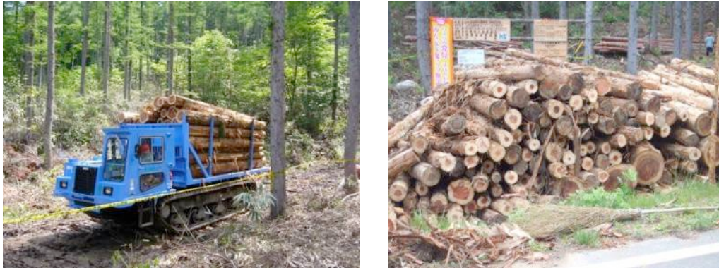
図 6-1-15 間伐材を運搬するフォワーダと伐り揃えられた間伐材
