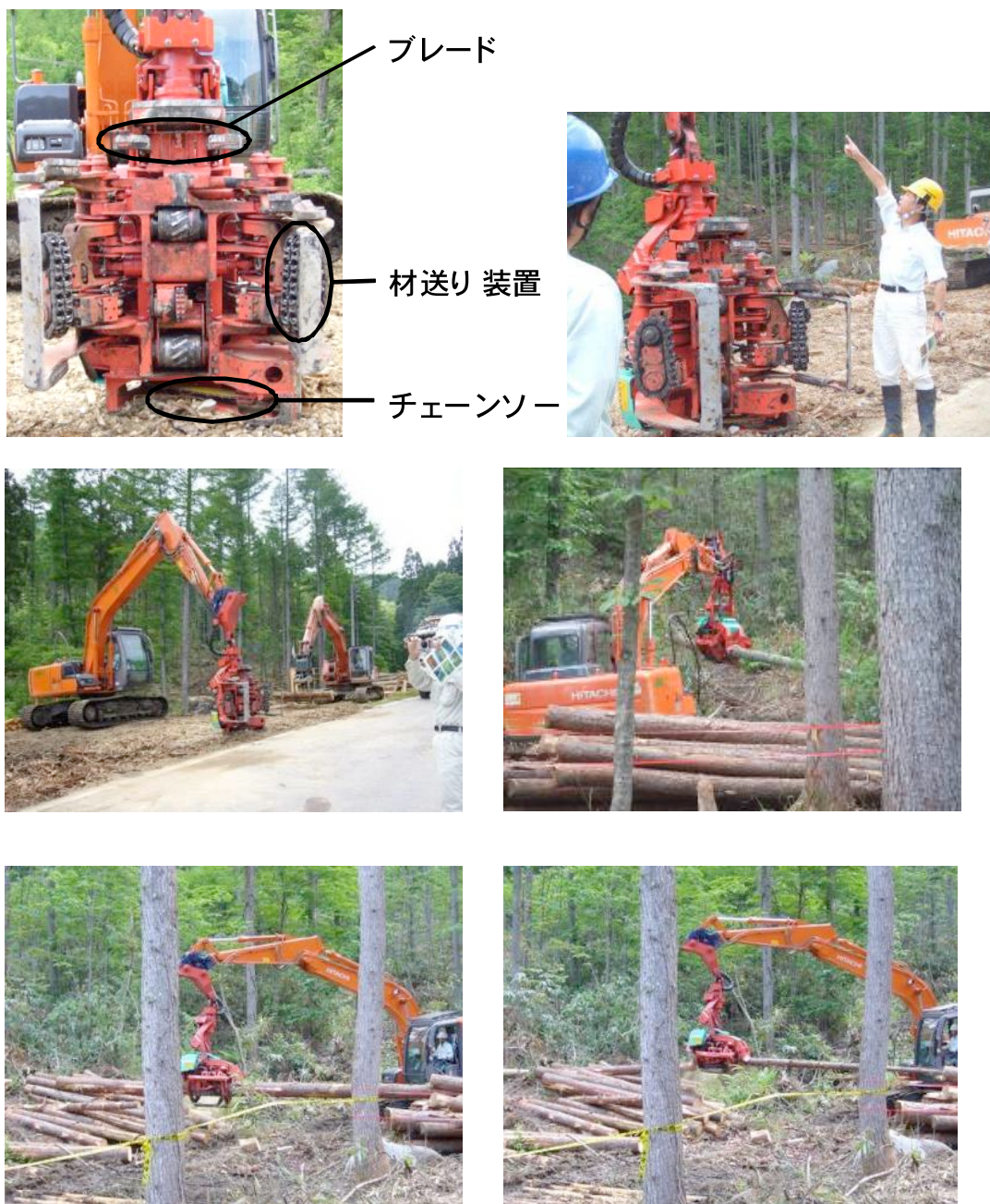
図6-1-14 ハーベスタによる伐採、造材の様子
