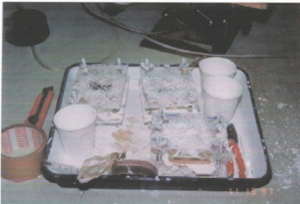
Photo 2-4 石膏枠の乾燥。2時間程度で固化する。 Gypsum frames drying for about 2 hours.
