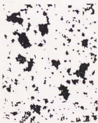
図15 2値化されたラテックス凝集反応の凝集パターン。 反応は、上左: —, 上右: +, 下左: ++, 下右: +++。
