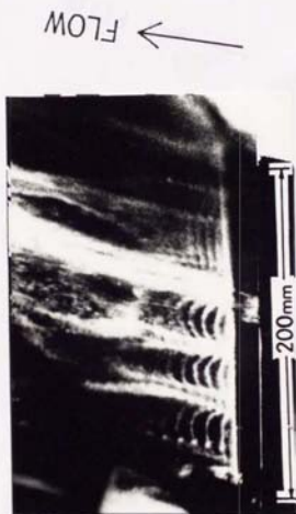
写真10 水素気泡法による並行流共存対流の伝熱面近傍 流動構造の可視化(強制対流域, Z = 5.05 \times 10^{-3} )
