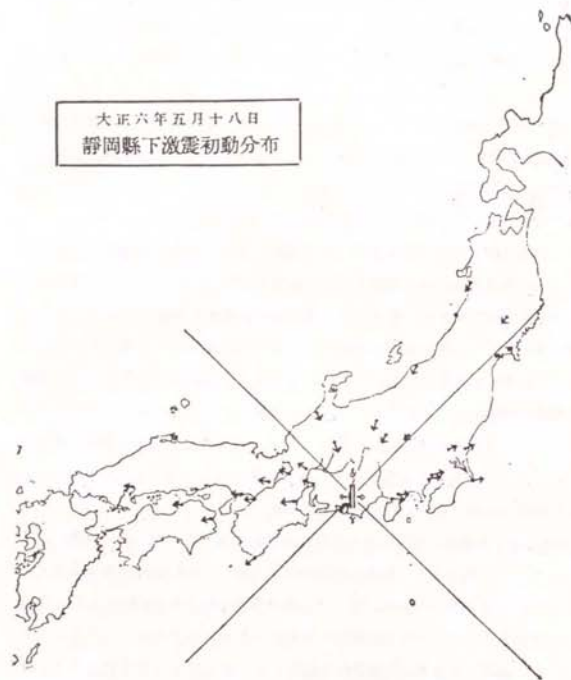
図 1.1 1917年5月18日静岡縣中部天竜川地震 (M 6.3) の P 波初動分布 [志田 (1929)*3 より引用]
