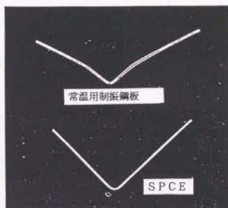
図10.5 室温での90度V曲げ成形の写真例
