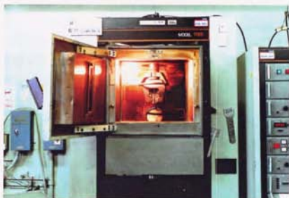
図2.3 恒温室を持つ能力5トンの 引張試験機の写真
