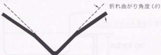
図10.3 折れ曲がり角度の測定方法
