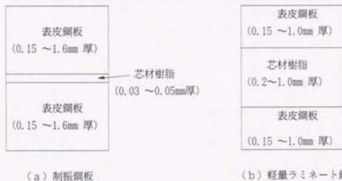
図7.1 樹脂複合鋼板の板厚構成略図 (板厚構成及び板厚構成比率は目安)
