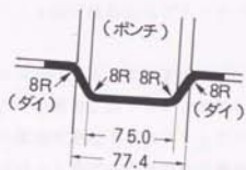
図5.2 温間用角筒ポンチ及びダイの寸法略図
