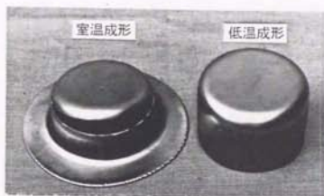
図8.2 ポンチ予冷却による円筒深絞り成形 による成形品の写真例
