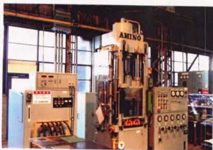
図8.7 温間及び低温成形用80トン複動式油圧プレス の全体写真
