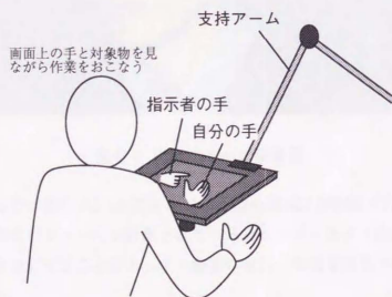
図 7.3: LCD と小型カメラを一体としたシステムの利用例
