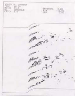
図3-5-10 (e) 旋回失速の発生・成長とセル数の変化：渦度分布と流線 (D2)
