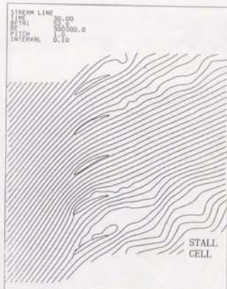
図3-4-3 (g) 微小変動から発達する旋回失速の流れ場 (B2)
