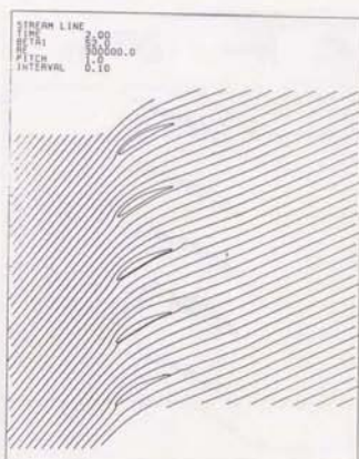
図3-4-3(a) 微小変動から発達する旋回失速の流れ場: 渦度分布と流線 (翼5枚, \beta_1 = 5.2^\circ , B2)
