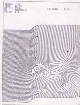
図3-5-13 (d) 失速セルの分裂と消滅：渦度分布と流線 (E1)
