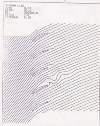
図3-4-3 (c) 微小変動から発達する旋回失速の流れ場 (B2)
