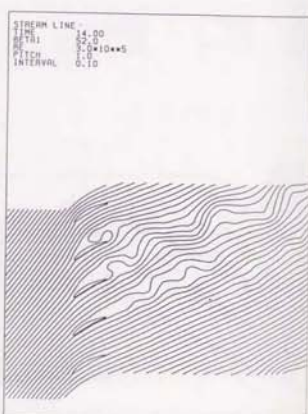
図3-3-2(c) \beta_1 = 52^\circ における旋回失速の伝播の様子 (A3)
