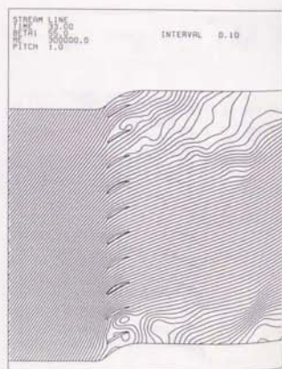
図3-5-13 (b) 失速セルの分裂と消滅：渦度分布と流線 (E1)
