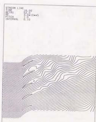
図3-3-2(d) \beta_1 = 52^\circ における旋回失速の伝播の様子 (A3)
