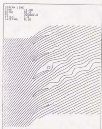
図3-4-3 (e) 微小変動から発達する旋回失速の流れ場 (B2)
