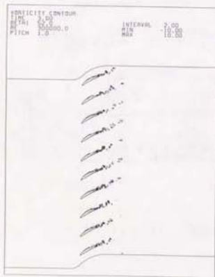
図3-5-3 (a) 旋回失速の発生・成長とセル数の変化：渦度分布と流線 (翼10枚, \beta_1 = 5.2^\circ , D1)
