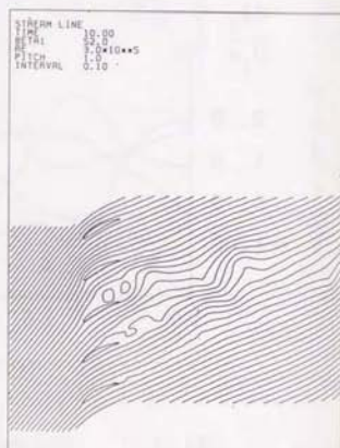
図3-3-2 (a) \beta_1 = 52^\circ における旋回失速の伝播の様子 渦度分布と流線 (翼5枚, A3)
