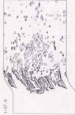
図 3-3-3 (d) \beta_1=75^\circ における旋回流速の伝播の様子 (A7)
