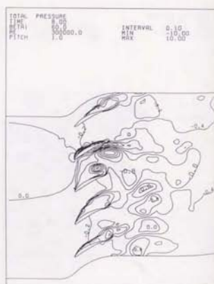
図3-2-2 (a) 旋回失速伝播時の静圧分布と全圧分布 ( \beta_1 = 60^\circ , 5ピッチ周期条件, 等高線間隔は上流動圧の20%, A1)
