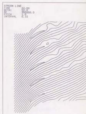
図4-2-21 (a) 予旋回の影響：渦度分布と流線 ( l/c=1 , \alpha_1=-45^\circ , \beta_1=52^\circ , K3 )
