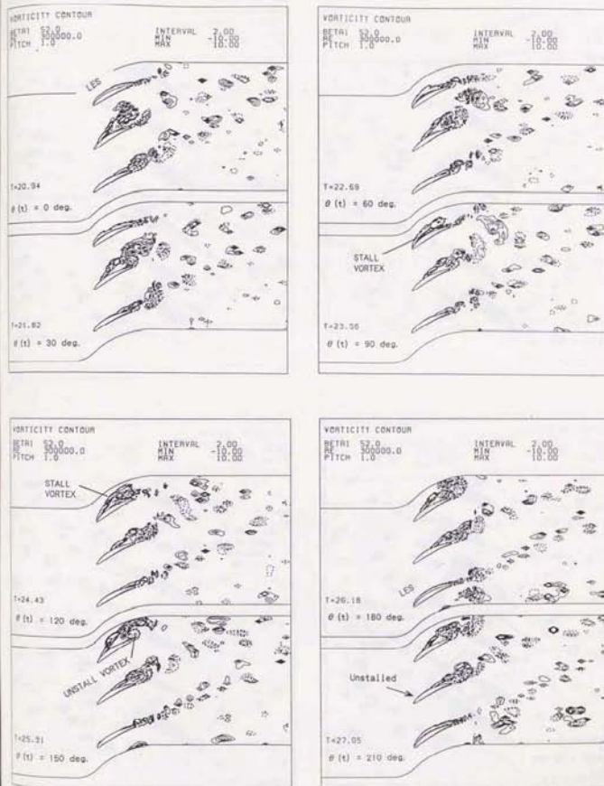
図5-3-4 (a) 非周期的な前縁失速の伝播：渦度分布 ( \sigma = 2.40^\circ , k = 0.3, Q3 )
