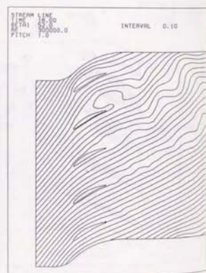
図4-2-17 (b) 予旋回の影響：渦度分布と流線 (K1)
