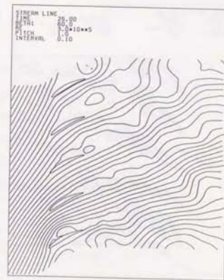
図4-2-4 (a) 翼列間隔の影響：渦度分布と流線 (翼5枚, L/c=2 , \alpha_1=0^\circ , \beta_1=60^\circ , JS)
