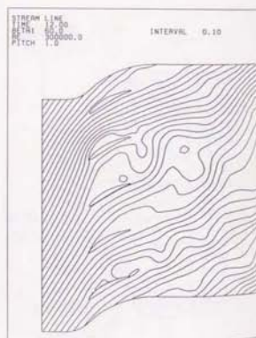
図4-2-19 (a) 予旋回の影響：渦度分布と流線 ( L/c=1 , \alpha_1=30^\circ , \beta_1=60^\circ , K2)
