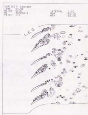
図5-4-5 (a) 同期・引き込み領域における3セルの旋回失速の発生：渦度分布 ( \alpha = 180^\circ , k = 0.2 , P3, 周期条件II)
