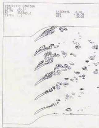
図5-3-33 (b) RS領域における旋回失速の伝播 ( \sigma = 60^\circ , k = 0.1 , T1)
