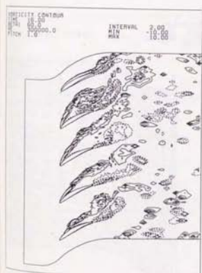
図4-2-19 (b) 予旋回の影響：渦度分布と流線 (K2)
