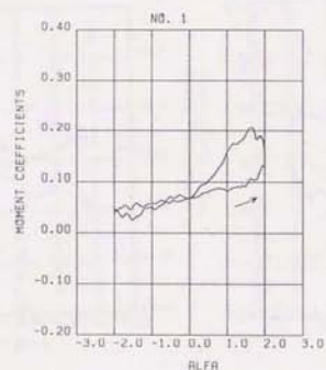
図5-2-29 非定常モーメントループの比較: \sigma = 240^\circ (a) k=0.15 , (b) k=0.2
