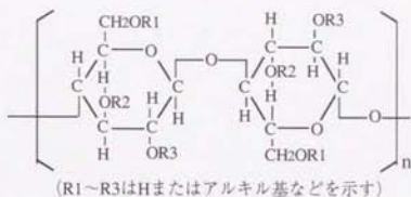
図-2.2.2 セルロース系水中不分離性混和剤の化学構造 (例) [2.2]
