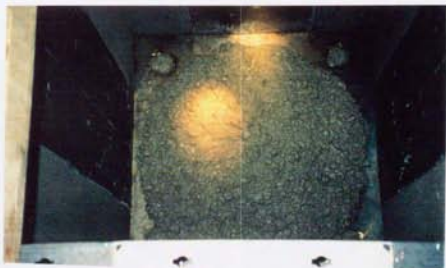
写真-6.3.3 超流動コンクリートのダイヤフラム部の通過状況
