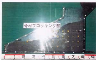
CASE-1 (分離抵抗性が小、粗骨材分離により閉塞) スランプフロー=74cm, 充填高さH=23.5cm
