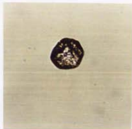
膨潤前（粉末：平均粒径 90\mu\text{m} ）
