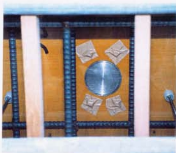
写真-5.6.1 側圧の測定方法
