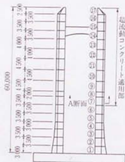
図-6.2.1 主塔形状およびブロック割り
