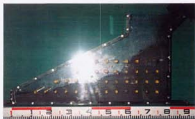
CASE-2 (充填性良好、流動勾配が小) スランプフロー=70cm, 充填高さH=33.5cm
