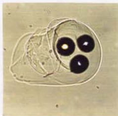
写真-2.3.3 3成分系結合材ろ液の温度の違いと膨潤ゲル形成状況
