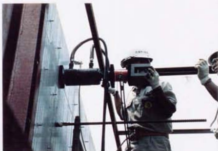
写真-4.2.3 水平鉄筋引き抜き試験要領
