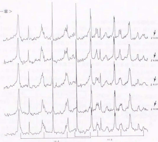
Fig. 1.28. ^{13}\text{C} NMR LSPD 実験 ( \delta 3.23:H-17, \delta 6.08:H-19 照射 11.5ppm: 18a-CH 3 観測、 \delta 6.27:H-23, \delta 6.38:H-21 照射 14.4ppm:22a-CH 3 観測)
