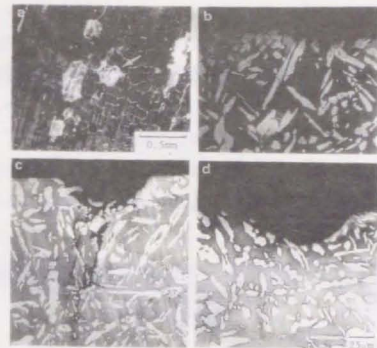
写真3 第2回実管腐食試験材、Cr222の腐食部:a)パイプ本体の表面:
