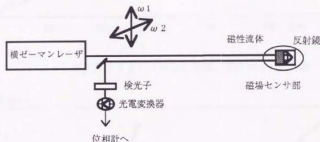
図3.12 直交2周波光を用いた磁気複屈折測定光学系
