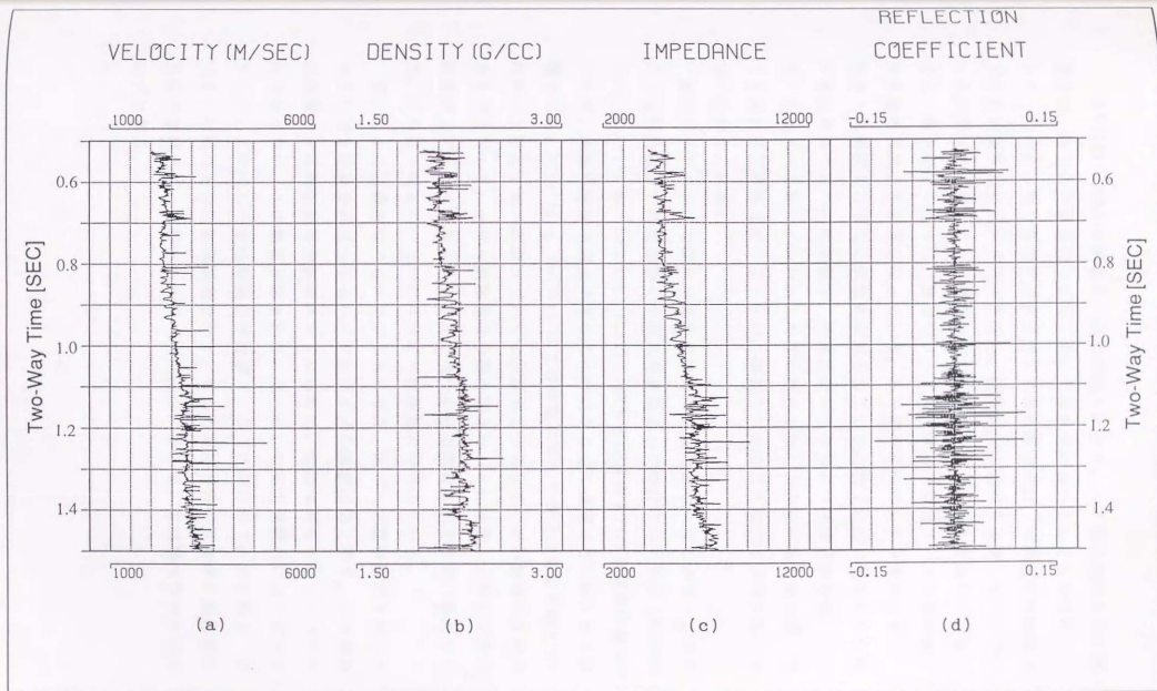
図2-3 坑井検層記録から作られた反射係数列を示す。左から各々、速度データ、密度データ、音響インピーダンスデータ、反射係数列を示す。
