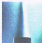
水銀灯を光源とし光 ファイバーを用いた シュリーレン写真
