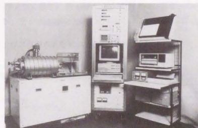
図 3.2.1. 静電容量型自動弾性率および内部摩擦測定装置
