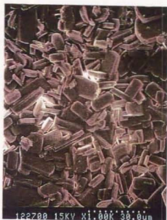
図3-6 25時間CVD処理膜の表面SEM写真
