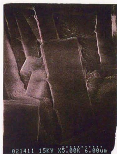
図3-11 27時間CVD処理膜の表面SEM写真
