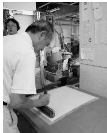
写真 9. 紙の乾燥作業(ローラー掛け)
