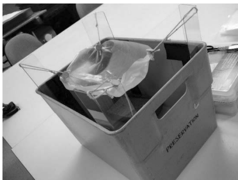
写真 10. 雨漏り対策装置の模型
