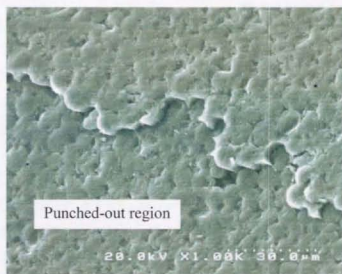
図 7.9 打ち抜き試験後の試験片表面の SEM 写真
