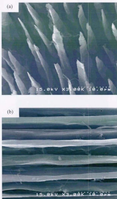
図 6.5 酸化後の C/C 複合材料の表面 SEM 写真
