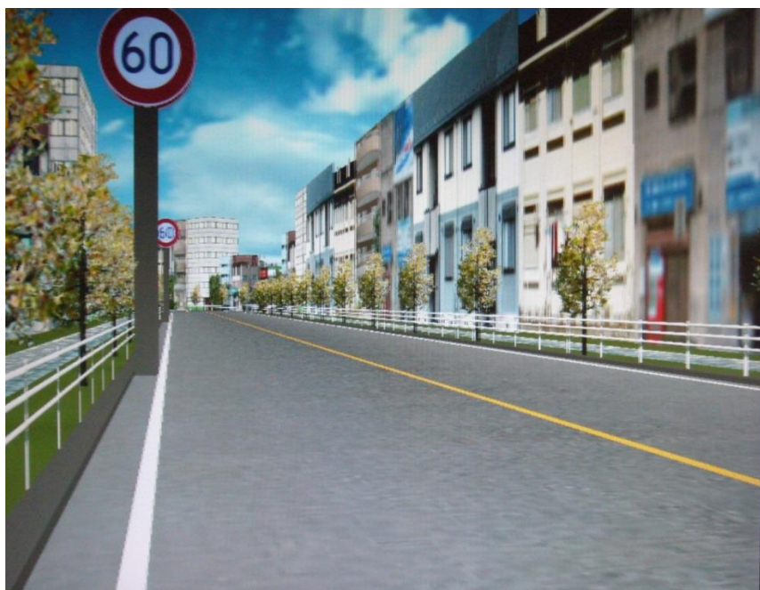
図 3-27 カーブの入り口前の速度提示標識
