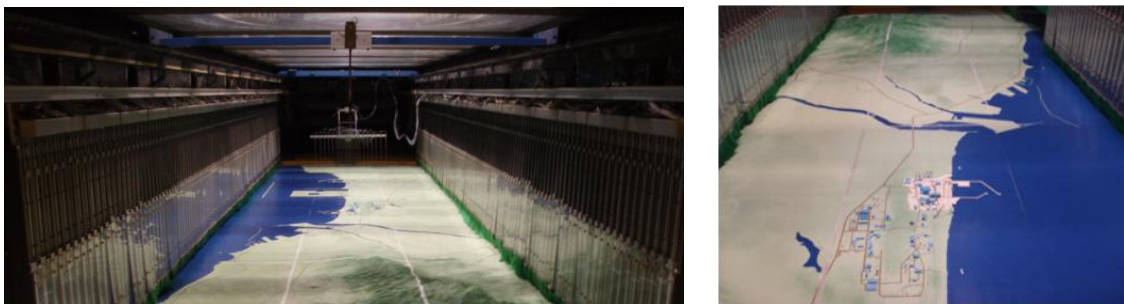
図 4.1.1 原子力発電所の安全審査用風洞実験例（日本原子力発電東海第二発電所）
