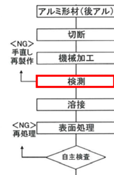
図 7-1 日本におけるアルミ型材生産フロー (出典：メーカーのパフレット)
