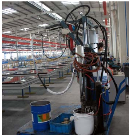
図 7-4 シーリング材を注入する設備 (撮影: 筆者)
