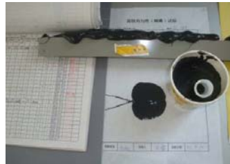
图 6-5 事例 CH1 における構造シーリング材の均質性試験と引っ張り破断試験試験の写真
