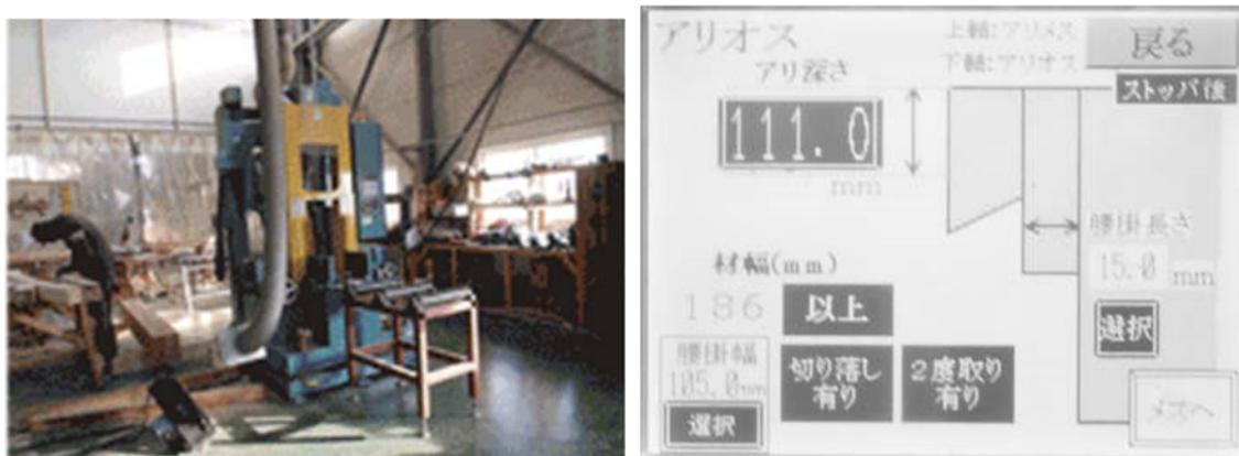
写真 3.4.6 プレカット機械<sup>203</sup>（左）と操作画面（右）
