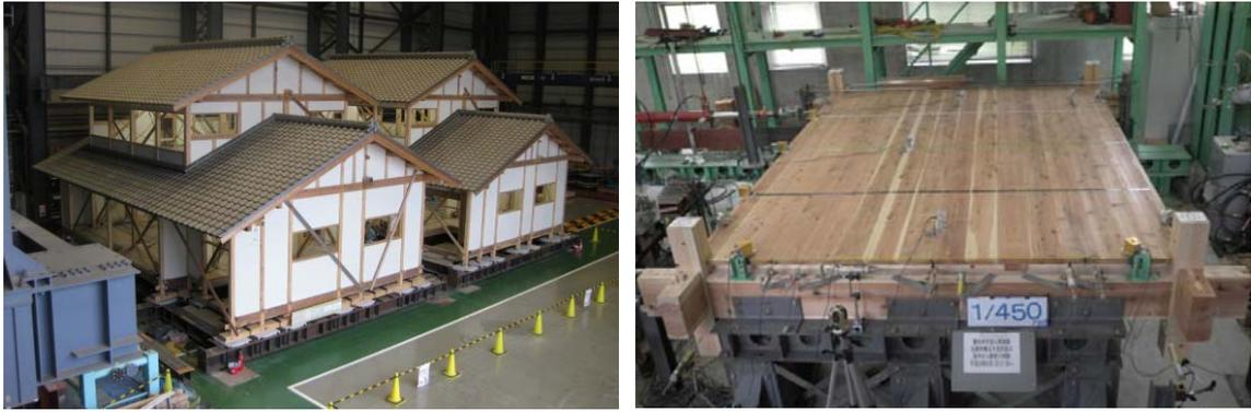
写真 3.3.3 実大振動台実験（左）と床版実験（右）の全景<sup>169</sup>
