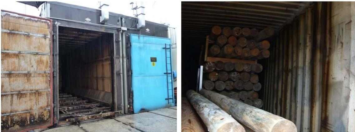
写真 3.4.7 製材所の乾燥装置
