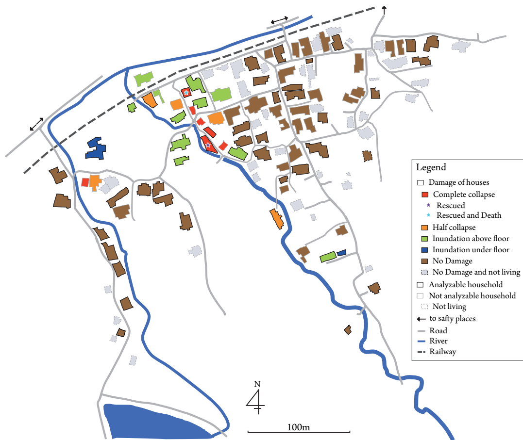
図 4.8 西楠崎地区における住戸の被害状況
