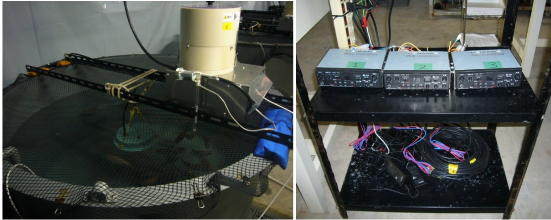
図 7-3 水槽内に設置した水中スピーカー（左）とスピーカーに接続したアンプ（右）
