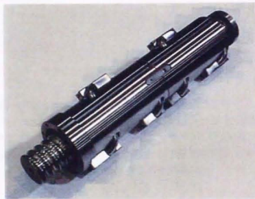
図 2.11.3 3000kN 機射出用のボールねじの外観
