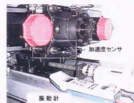
図 4.5.4 加速度センサ(振動計)の取り付け
