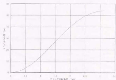
図 2.5.3 クランク回転角とスライダの位置
