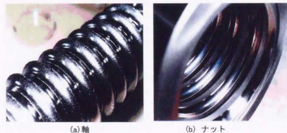
図 2.9.4 ボールねじの損傷状態
