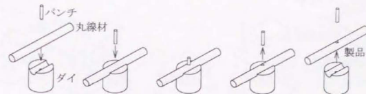
図 7.10 直径 0.35mm 丸線丸穴打抜き工具による加工の模式図
