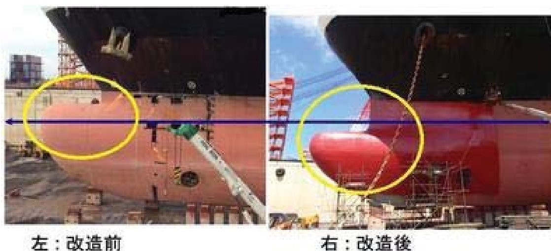
図 A2-3 バルバスバウの改造 (船型や運航条件に併せてバルバスバウの形を改造) [5]
