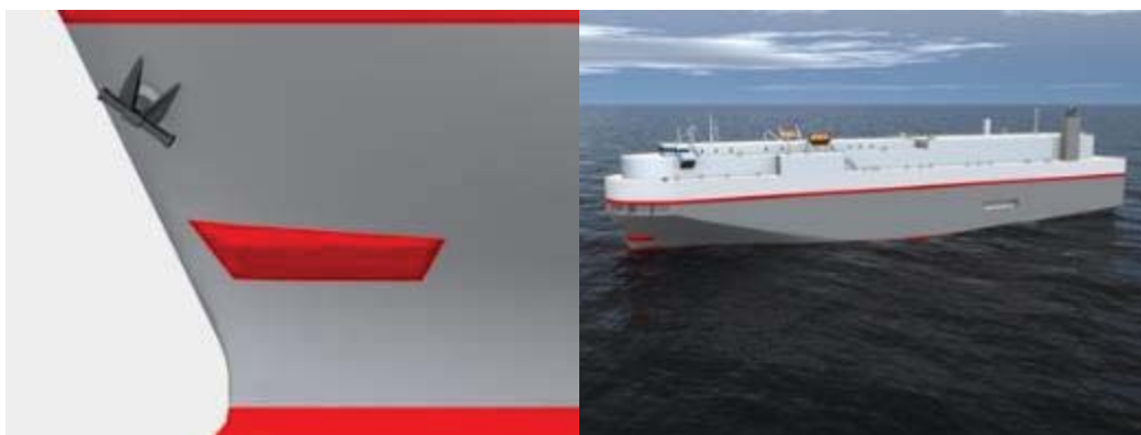
図 A2-4 実船性能モニタリングによる省エネ装置「ステップ」の検証事例 [8],[9]
