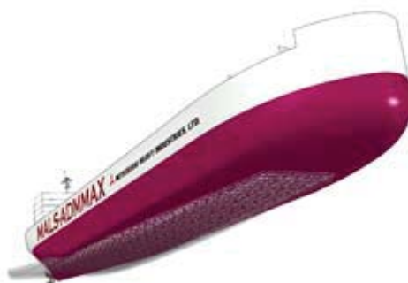
図 A2-7 空気潤滑システムを採用したポストパナマックス型のばら積み貨物船 [8],[11]
