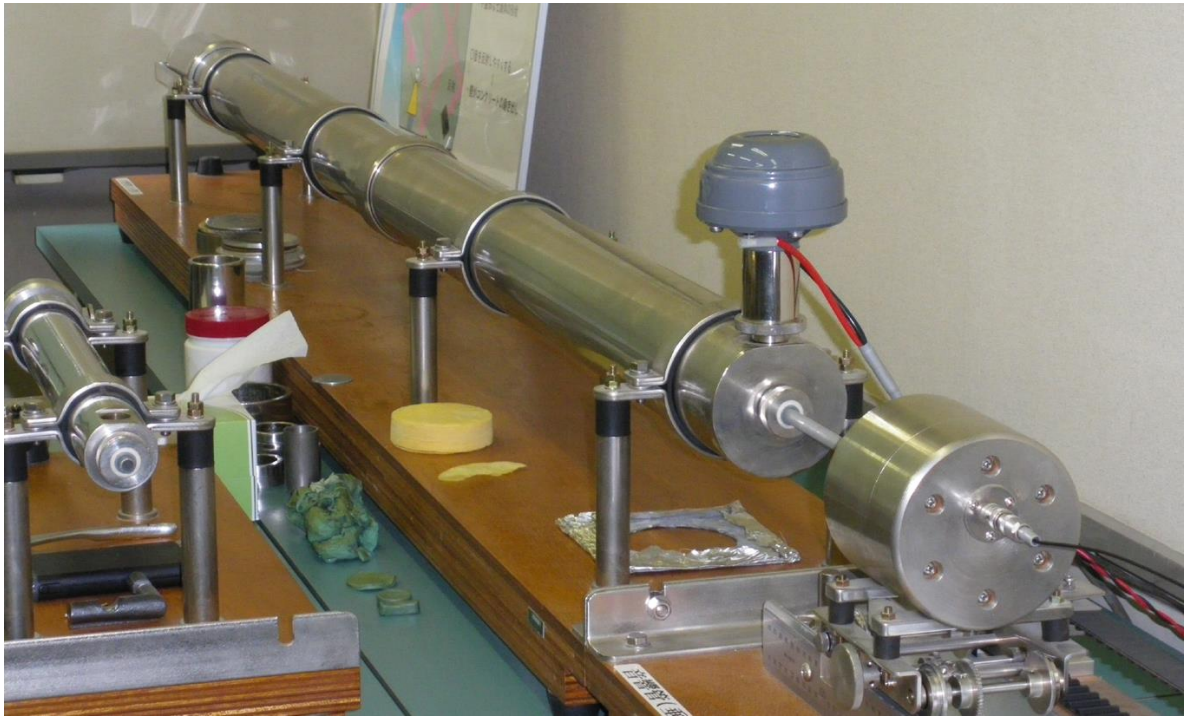
図 10 JIS 規格の垂直入射音響管測定装置（於：東京都立産業技術研究センター）
