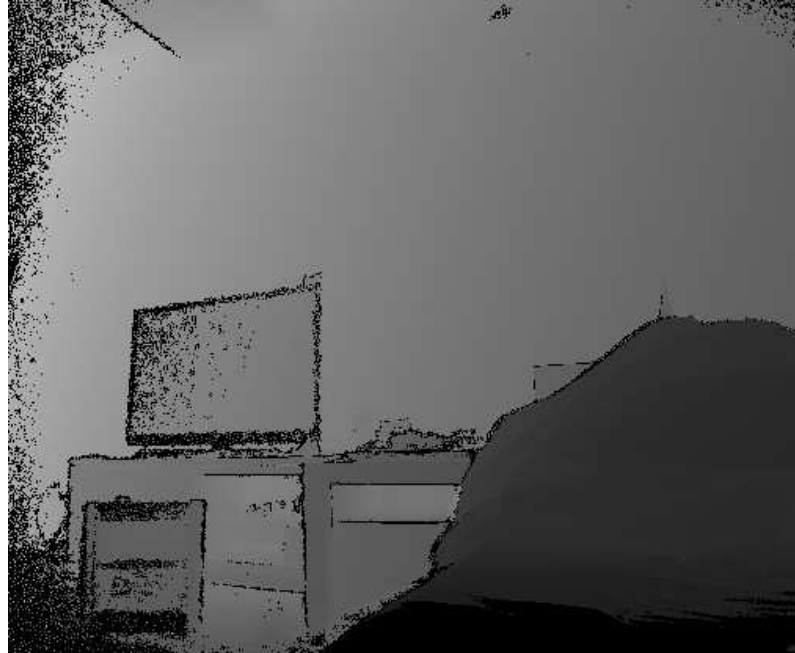
图 3.9: Edge filtered raw data
