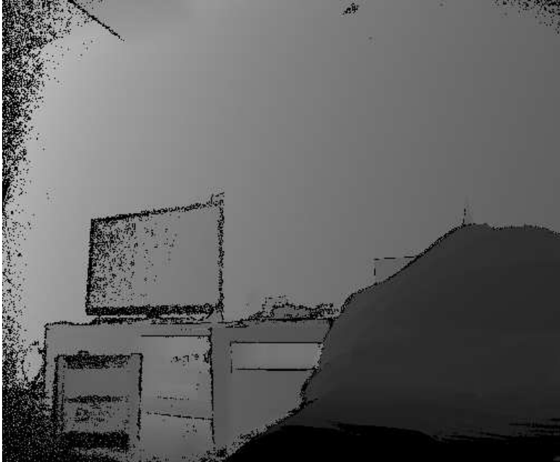
图 3.8: Edge filtered raw data
