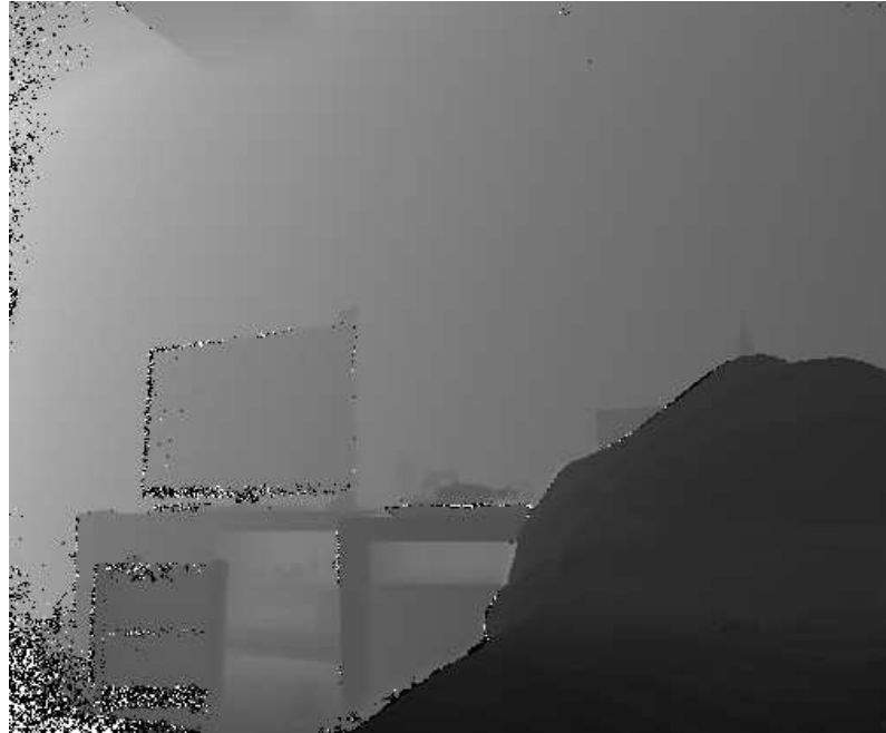
图 3.7: Bilateral filtered raw data
