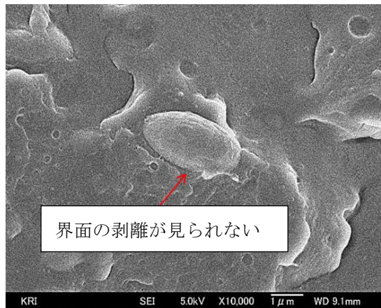
図 3-6 電子顕微鏡 SEM で撮影されたパラミロン 20 部を加えたポリプロミレン複合体の写真
