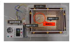
研究①ではまず、右図に示す温熱刺激装置を考案・開発した。続いて、予備実験の結果を基に温熱刺激プロトコール(暑熱環境への曝露: 40℃, 30 min /day)を設定し、その妥当性を検証した。その結果、①本研究の温熱刺激プロトコールは、十分に生理学的応答(直腸温の上昇)・生化学的適応(骨格筋の HSP72 の発現量増加)を誘導すること、②熱中症の病態(42.0℃を越える直腸温,血中乳酸濃度の上昇)を示さないこと、③暑熱環境への暴露は、マウスの自発活動量に影響を与えないことを示した。これらの結果は、本研究で採用した温熱刺激方法の妥当性を保証するものである。
