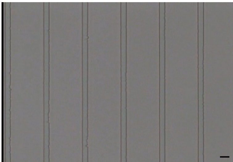
図 3.12: レジスト (AZ P1350) をコートしマスクを介して UV を照射し現像したガラス基板。レジストが溶解しなかった部分 (幅の狭い領域) は, 約 6.5 \mu\text{m} の幅を持った。レジストが溶解した部分 (幅の広い領域) でのみシランがコートされ, またプルロニックがコートされることになる。スケールバーは 10 \mu\text{m} を表す。
