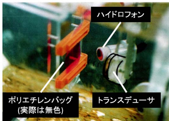
Fig. 4.12 キサンテン系増感剤のキャビテーション生成能の測定系
