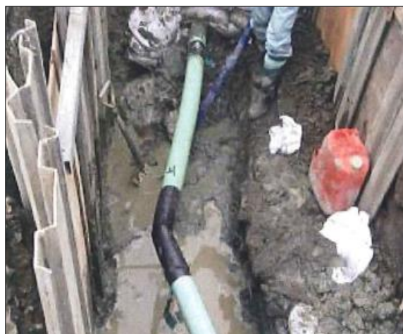
図-1.17 座屈被害状況 10)
