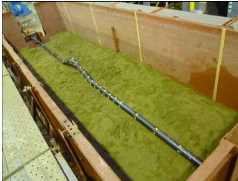
図-4.5 土槽実験での長管座屈変形状況（全体）
