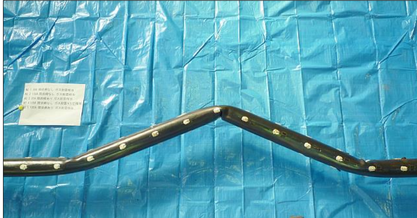
図-4.4 土槽実験での長管座屈変形状況（座屈部拡大）
